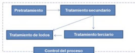
El pretratamiento abarca la medición de caudales, tamizado, desarenador - desgrasador y tanque de homogenización de caudales.
